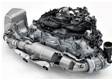
Auffällig beim neuen GTS-Sechszylinder-Boxermotor ist, dass er nur noch einen Abgasturbolader auf der rechten Fahrzeugseite aufweist (statt wie bei allen anderen Varianten zwei). Nicht nur eine E-Maschine zwischen Verbrenner und Achtgang-Doppelkupplungsgetriebe wird eingesetzt, sondern erstmals ein Abgasturbolader mit E-Antrieb/-Rekuperation. Foto: Porsche
