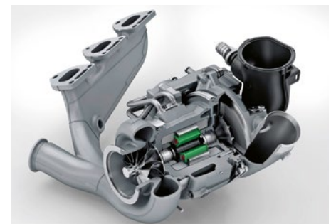
Wie in der Formel 1: Ein elektrisch antriebbares oder als Rekuperationssystem ausgelegtes Laufzeug versorgt mit im Durchmesser statt 50 neu 80 mm messendem Turbinen- und Verdichterrad alle Zylinder mit verdichteter Luft. Statt bei der Ladedruckgrenze mittels Bypassklappe Abgas vorbeiströmen zu lassen, kann das Turbinenrad die E-Maschine antreiben. Foto: Porsche
