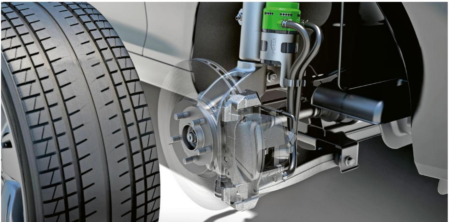
Die Zulieferindustrie tüfelt an Absaugvorrichtungen oder passiven Filtersystemen, um den Bremsstaub der Brems Scheibenvarianten während dem Verzögerungsvorgang abzusaugen (aktiv) oder aufzunehmen (passiv). Foto: Tallano
